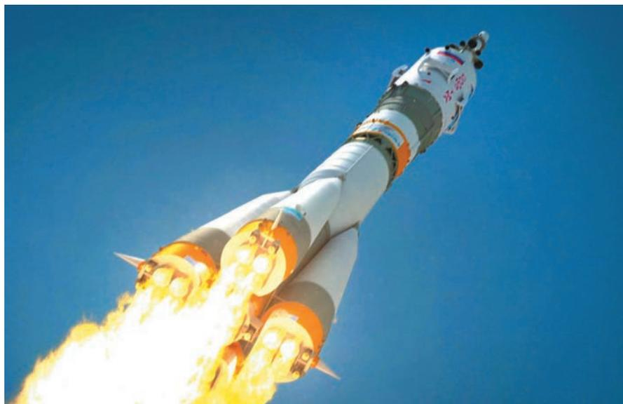
Для аппаратов, двигательная установка которых работает на участке выведения, выбранный способ ускорения должен обеспечить преодоление земного притяжения — придать аппарату первую космическую скорость, которая для Земли составляет около 7,9 км/с, соответственно, для этого необходима высокая мощность химического реактивного двигателя.
