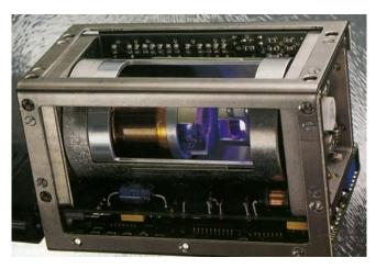
Компания Frequency Electronics (FEI) заявила о том, что она завершила критический анализ конструкции атомных часов следующего поколения (обозначены как Rubidium). Работы проводятся в интересах потенциальной возможности использования генеральным подрядчиком по программе GPS III Follow On (GPS IIIF) BBC США — компании Lockheed Martin.
