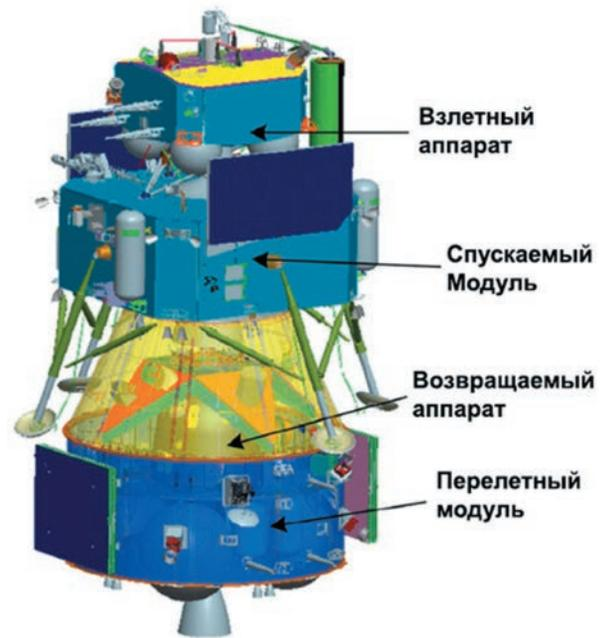
Спускаемый модуль «Чанъэ-5»
