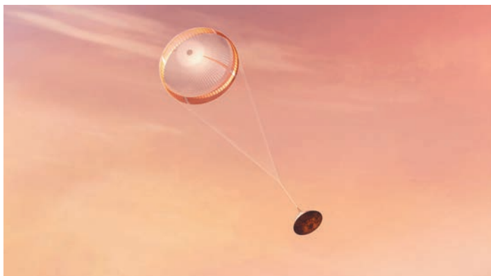
Марсоход Perseverance разворачивает сверхзвуковой парашют из своей аэрозольной оболочки, замедляясь перед приземлением на поверхность Марса. Фото: НАСА / JPL-Caltech через AP
