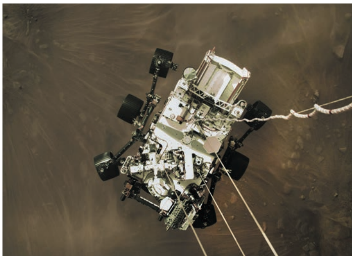
Марсоход Perseverance, опущенный к поверхности Марса во время его энергетического пуска. Марсоход показан с необычайной детализацией всего на высоте 2 метра над поверхностью, его опускают с помощью тросов, прикрепленных к мостовому крану, а красная пыль поднимается ракетными двигателями. 18 февраля 2021 г.
