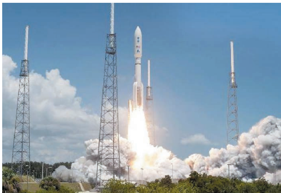
Perseverance запущен на ракете Atlas V-541 на мысе Канаверал. «Атлас V» — одна из самых больших ракет, предназначенных для межпланетных полетов. Это ракета того же типа, с помощью которой на Марс были запущены InSight и Curiosity
