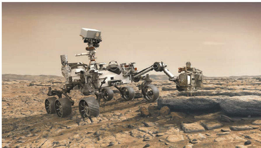
Perseverance — это 6-колесный марсоход размером с компактный автомобиль: около 3 м в длину, 2,7 м в ширину и 2,2 м в высоту. Но при весе 1025 кг он весит меньше, чем компактный автомобиль. Его конструкция разработана на основе удачной разработки, примененной на марсоходе Curiosity. Фото: НАСА / JPL-Caltech
