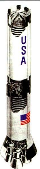
По мнению разработчиков, упрощение – ключ к успеху BA-1. При проектировании ракеты «с запасом» можно обойтись без применения высоконапорного топлива и сложных узлов и агрегатов, увеличивающих эффективность, но резко взвинчивающих ее стоимость. «Всю жизнь я не понимал, почему этого не сделали ранее», – говорит Э.Бил.
