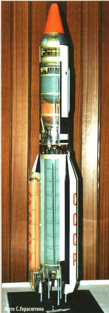
Макет двухступенчатой МБР УР-500
