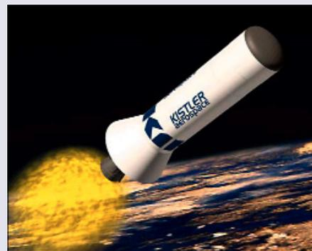
**После разделения вторая ступень – «орбитальный аппарат» – включает двигатель AJ26-НК43 и выходит на низкую орбиту**
