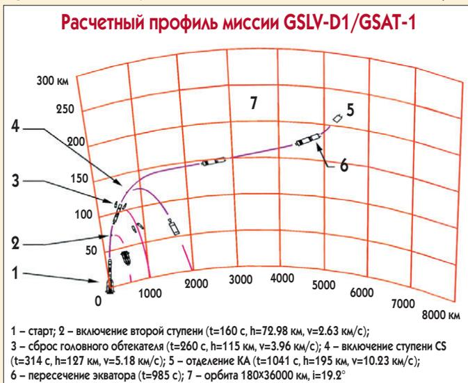
Старт прошел точно в назначенное время. Ускорители, первая и вторая ступени носителя функционировали штатно, однако криогенный ЖРД российского производства КВД-1, которым была оснащена третья ступень, проработал 698 сек вместо положенных 710. Недобор скорости составил 0.6% относительно расчетной (10.2 км/с), то есть около 60 м/с. GSAT-1 был отделен в 5000 км от места запуска на более низкой орбите, чем планировалось.
