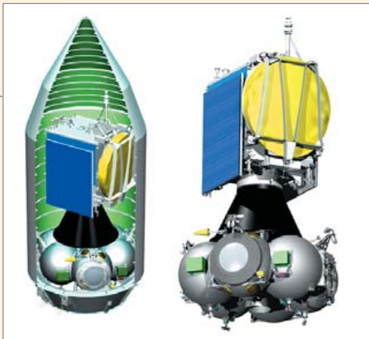
Конфигурация головной части РН со спутником Galaxy 14 и РБ «Фрегат»
