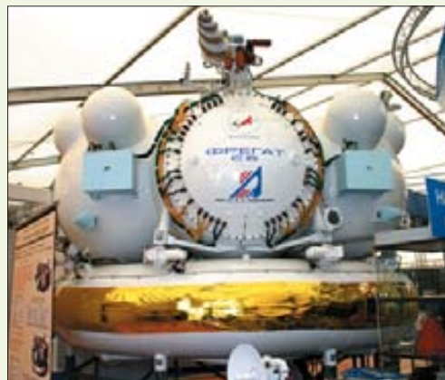
Перспективный разгонный блок «Фрегат-СБ» производства НПО имени С.А.Лавочкина. Благодаря дополнительному сбрасываемому торовому баку (содержит 3100 кг топлива) возрастет масса выводимого на орбиту груза
