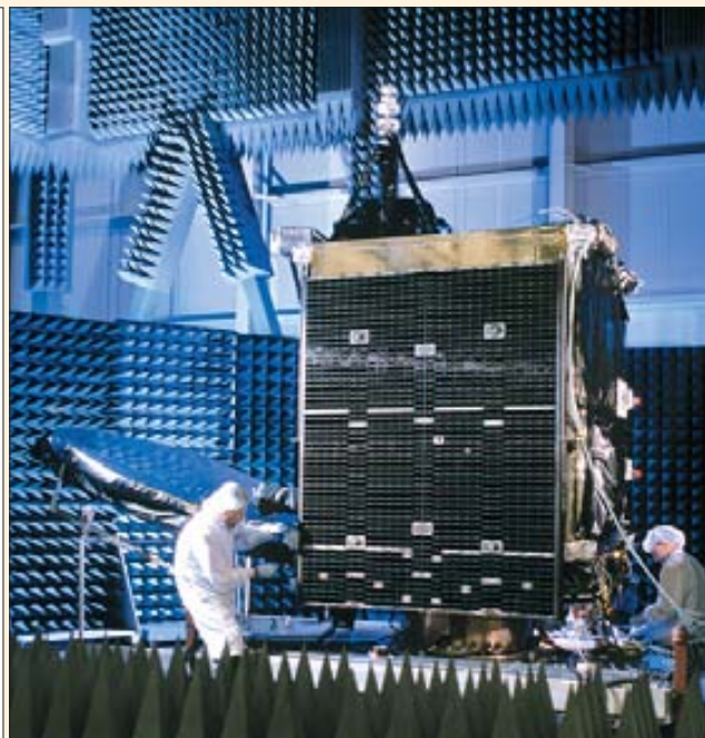
Спутник Galaxy 14 в беззавихорной камере компании Orbital Sciences
