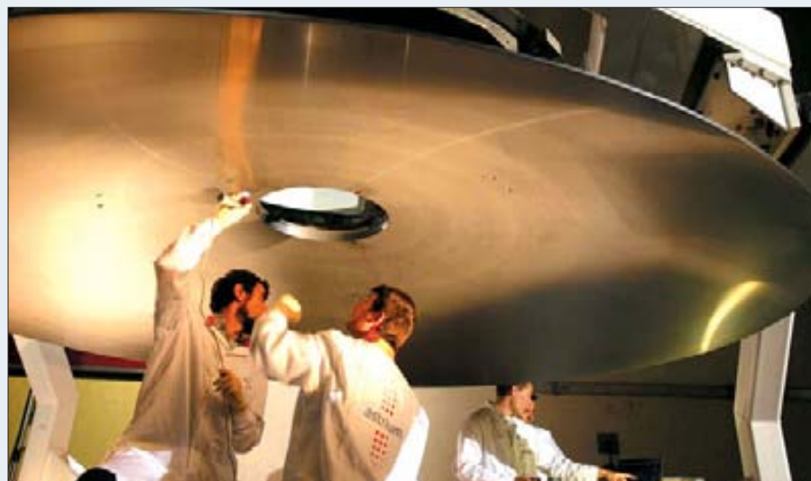
Основное зеркало телескопа Herschel проходит ультразвуковые исследования. EADS Astrium SAS, 25 мая 2005 г.
