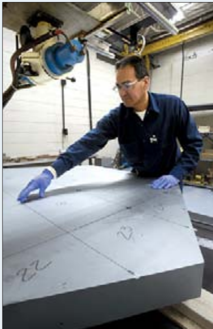
Бериллиевый сегмент для зеркала телескопа Вебба, расчерченный на 24 секции, перед тестированием с помощью рентгеновского излучения
