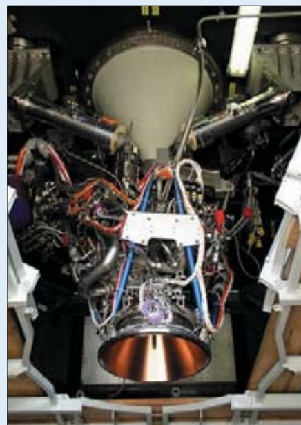
Криогенный Vinci перед испытаниями
