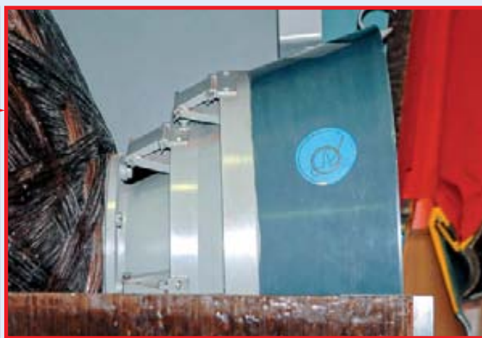
Макет ракетного двигателя твердого топлива производства пермского НПО «Искра» и механизм раздвижения его соплового насадка
