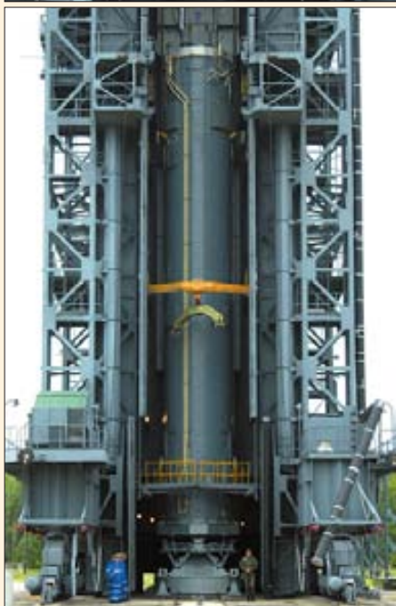
Подъем КГЧ и РН «Рокот» в башне обслуживания
