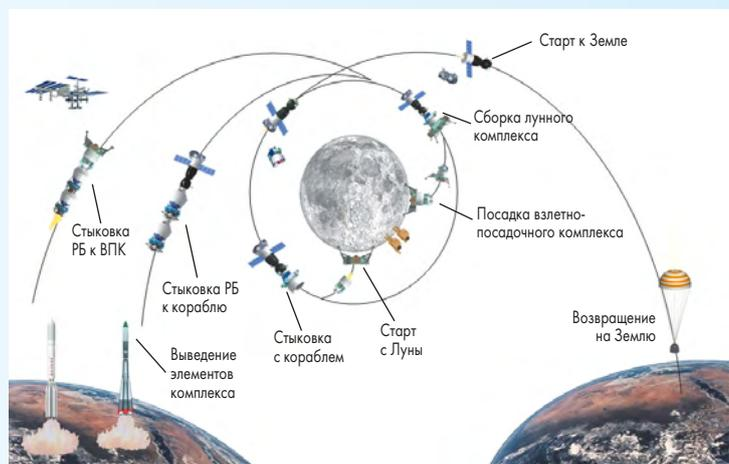
▲ Схема полета с высадкой экипажа на поверхность Луны
