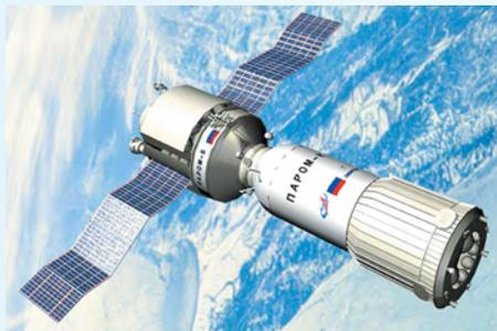
«Паром» имеет два активных стыковочных узла: один для стыковки к контейнеру или к кораблю «Клипер», а другой для стыковки к орбитальной станции. Буксир имеет двигательную установку, оснащён баками с долгохраняемыми компонентами топлива и солнечными батареями для электропитания бортовых систем.
