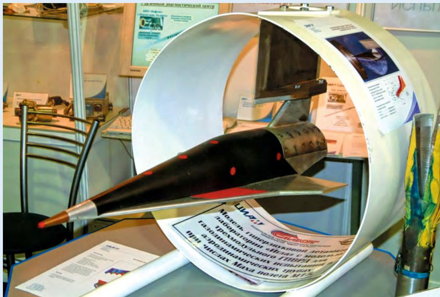
▲ Модель ГЛЛ «Игла» для испытаний в гиперзвуковой аэродинамической трубе
