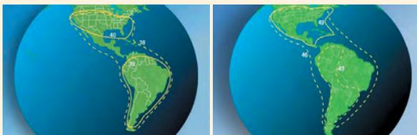
▲ Зоны покрытия ретрансляторов КА SatMex 6
