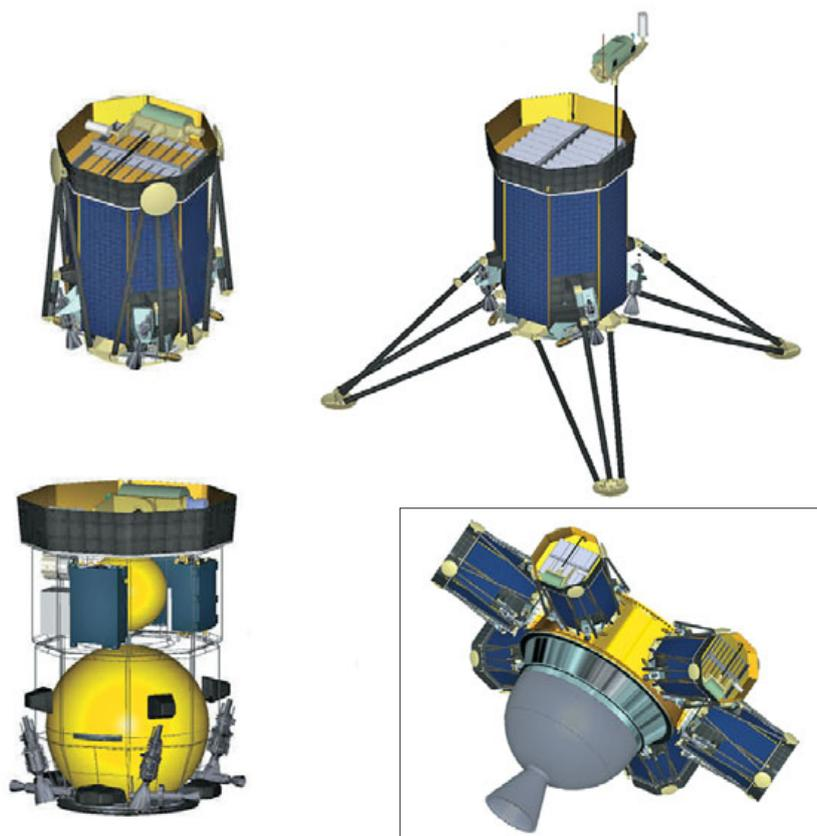
▲ Вариант компоновки посадочного аппарата проекта Lunette для запуска в качестве попутной полезной нагрузки на переходнике ESPA носителя типа EELV
