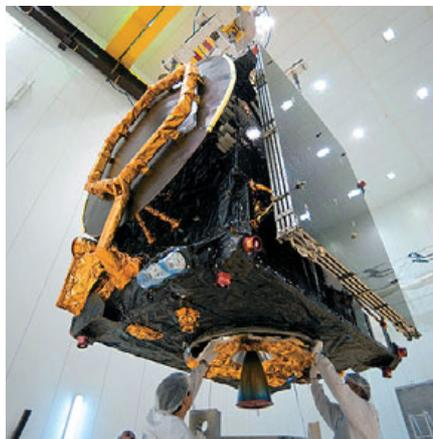
Аппарат NileSat 201 изготовлен на основе платформы Spacebus-4000 ВЗ. Его стартовая масса – 3200 кг, стартовые габариты – 2.9×1.8×2.8 м. Система электропитания включает две панели четырехсекционных солнечных батарей размахом 29.6 м. Они обеспечат в конце расчетного 15-летнего срока существования КА мощность не менее 7 кВт, из которых 5.7 кВт предназначены для полезной нагрузки. NileSat 201 оснащен жидкостным двухкомпонентным апогейным двигателем S400, имеет трехосную систему ориентации.
