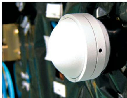
▲ Двигательный модуль MEMS имеет размер мячика для гольфа (диаметр 43,5 мм, высота 51 мм). Внутри располагается «тяговый чип». По экватору устройства видны отверстия сопел
