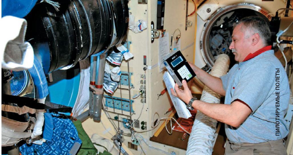
▲ В руках у Фёдора измеритель концентрации аэроионов ИКАР-1, используемый в эксперименте «Ветерок»
