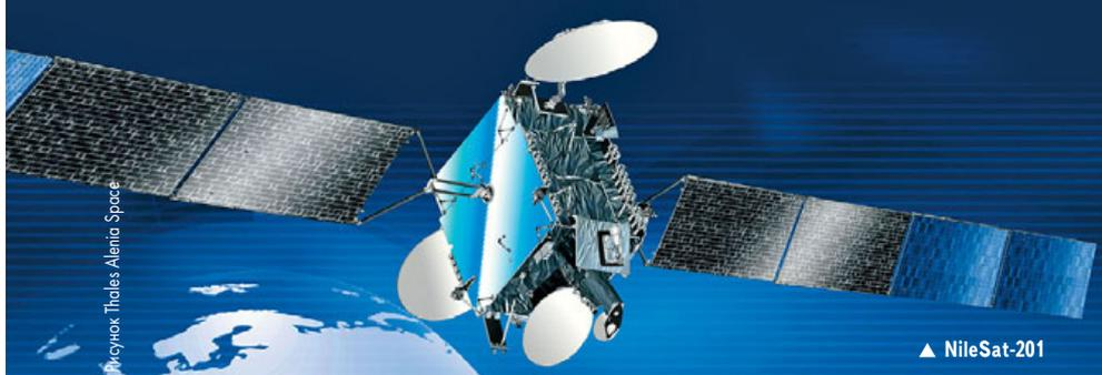
вители компании Thales Alenia Space сообщили, что на борту произошла утечка гелия, используемого в вытеснительной системе подачи топлива. Специалистам пришлось разрабатывать новую схему доведения КА. Лишь в самом конце января 2008 г. спутник оказался на геостационарной орбите в расчетной точке 2.85° в.д., а 7 февраля было объявлено, что вместо расчетных 15 лет он проработает всего 2.5–3 года.
