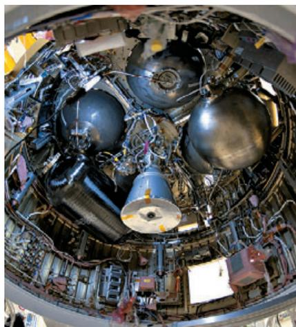
▲ Ступень AVUM на сборке и вид на двигательную установку производства КБ «Южное»
