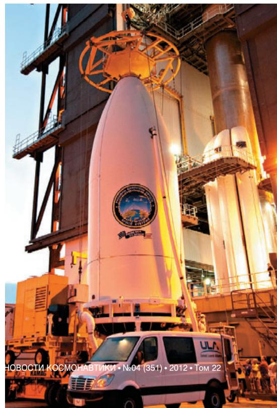
\* Имеет цилиндрическую вставку высотой 2.7 м, в отличие от стандартной (короткой) версии.
