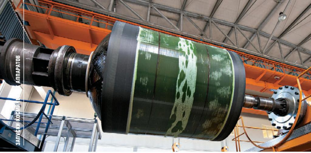
▲ Изготовление заряда двигателя Zefiro-9
