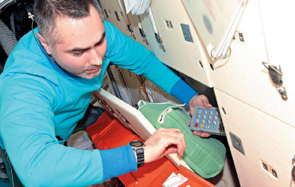
▲ Евгений Тарелкин производит замеры радиационного фона дозиметром «Люлин-5»
