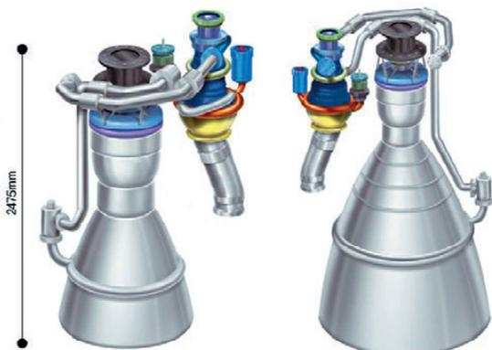
▲ На первой ступени KSLV-2 будут установлены четыре «земных» двигателя тягой по 75 тс (слева), на второй – один, с высотным соплом
