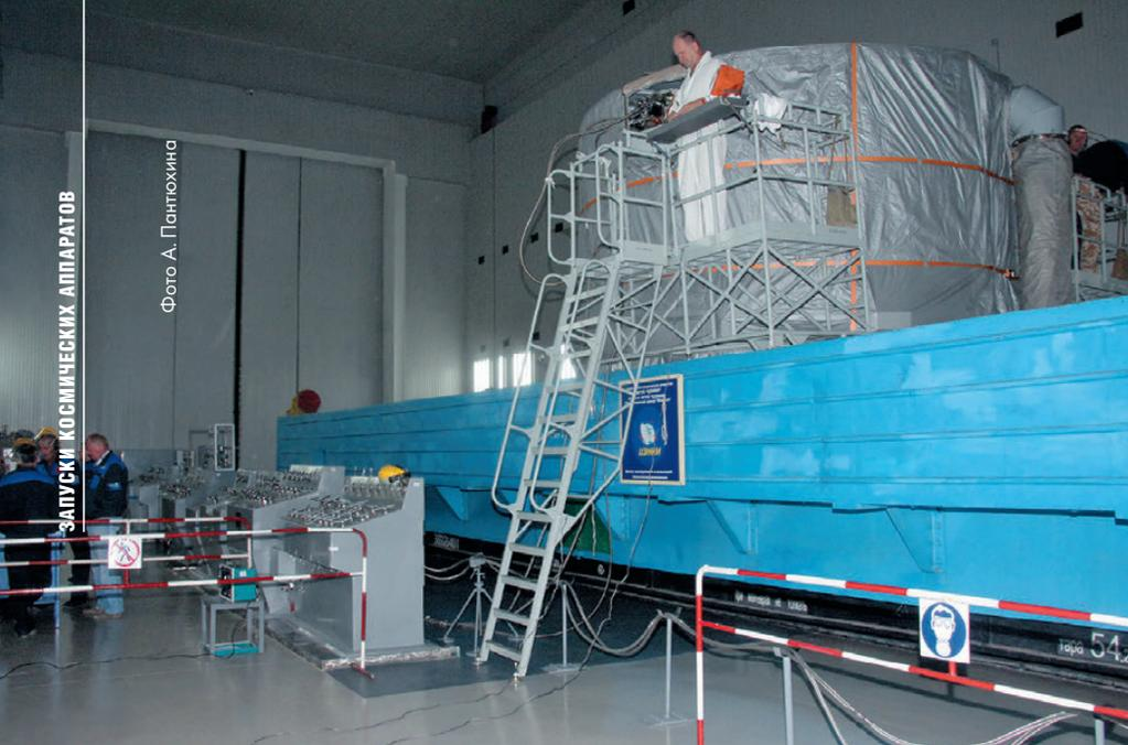
▲ Перед заправкой разгонного блока «Бриз-М» компонентами топлива
