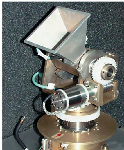
▲ Рупорная антенна X-диапазона с двухступенным приводом
