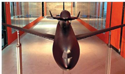
▲ Продувочная дозвуковая модель связи самолета-носителя и ракетоплана
