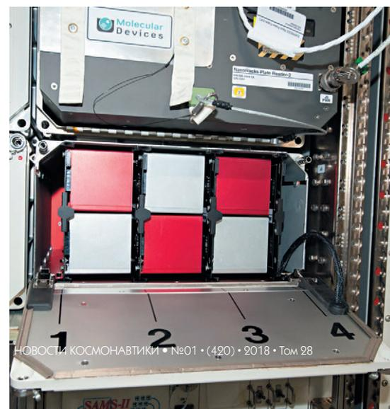
го модуля класса CubeLab 1U, допуская их различную конфигурацию при возможности автоматического одновременного проведения исследований. Payload Card оснащена разъемами для крепления CubeLab и подключения их к системам электропитания и передачи данных. Предусмотрена возможность запитки аппаратуры, рассчитанной на напряжение постоянного тока 3.3, 5 и 12 В.
