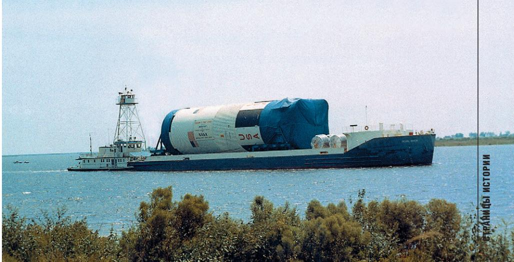
▲ Ступень S-IC транспортируется в Мичуд из Центра Маршалла после огневых испытаний
