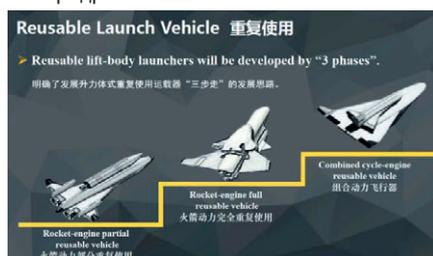
▲ Третьим этапом создания многоразовой системы китайские разработчики видят аппарат с комбинированной двигательной установкой по типу Skylon
