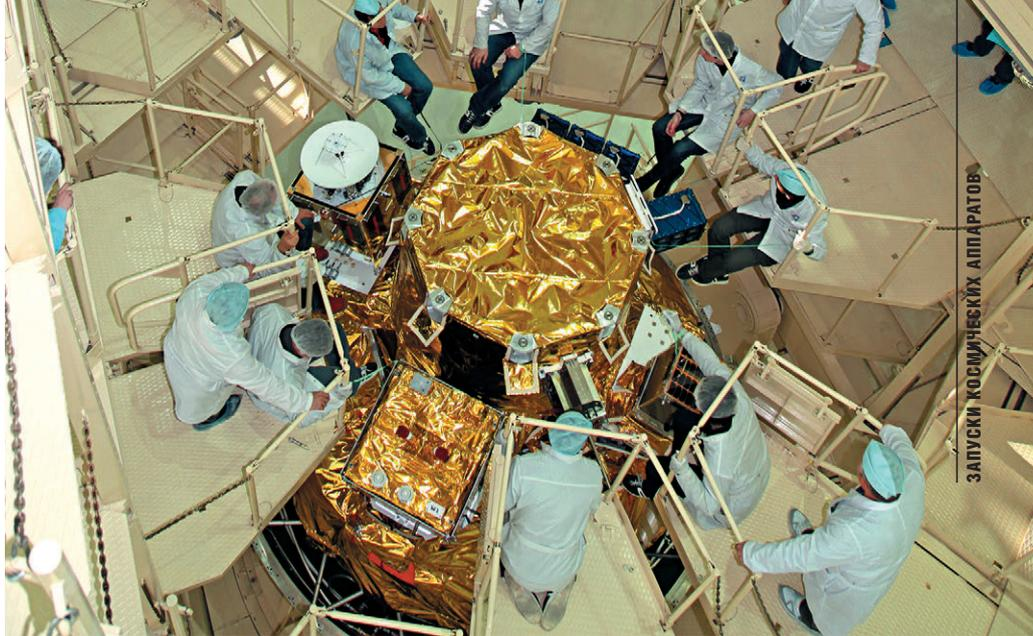
▲ Разгонный блок «Фрегат» и установленные на нем попутные спутники
