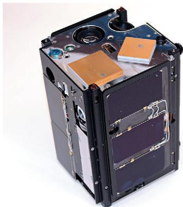
▲ Спутник оптической связи OCSD
