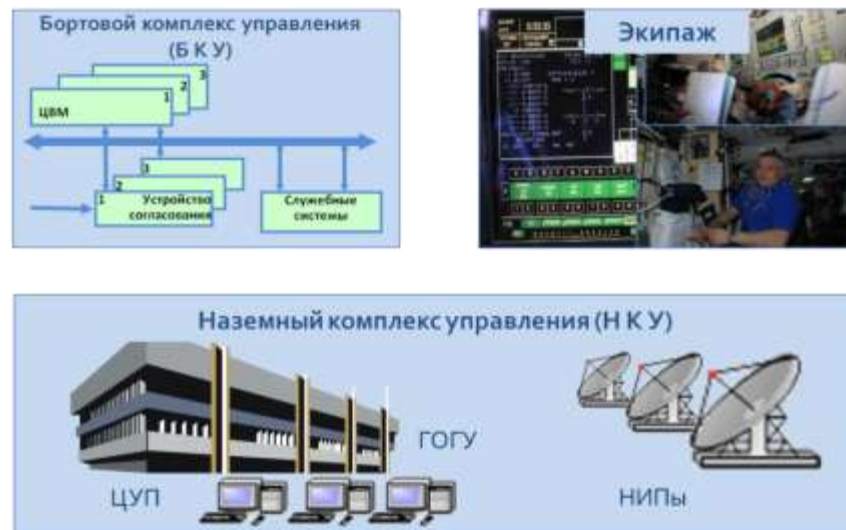
Рис. 3. Основные составляющие системы управления полетом пилотируемых космических аппаратов
