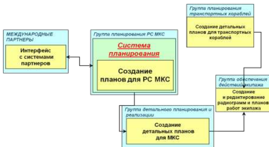
Рис. 7. Структура автоматизированной системы планирования РС МКС
