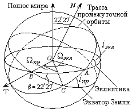
Рис. 6. Взаимная связь геоцентрических экваториальных \Omega_{np} , i_{np} и гелиоцентрических эклиптических \Omega_{экл} , i_{экл} координат плоскостей промежуточных орбит
