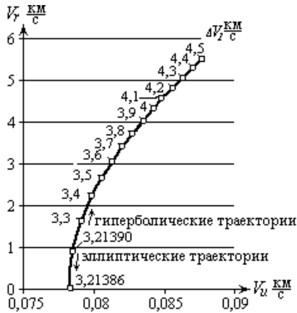
Рис. 12. Радиальная V_r и горизонтальная V_u составляющие геоцентрической орбитальной скорости на границе сферы действия Земли при различных импульсах \Delta V скорости на промежуточной орбите
