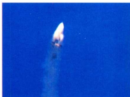
На высоте 300 м САС отстреливается от корабля
