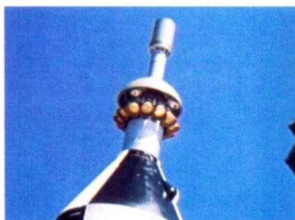
Видны сопла двигателей аварийного спасения
