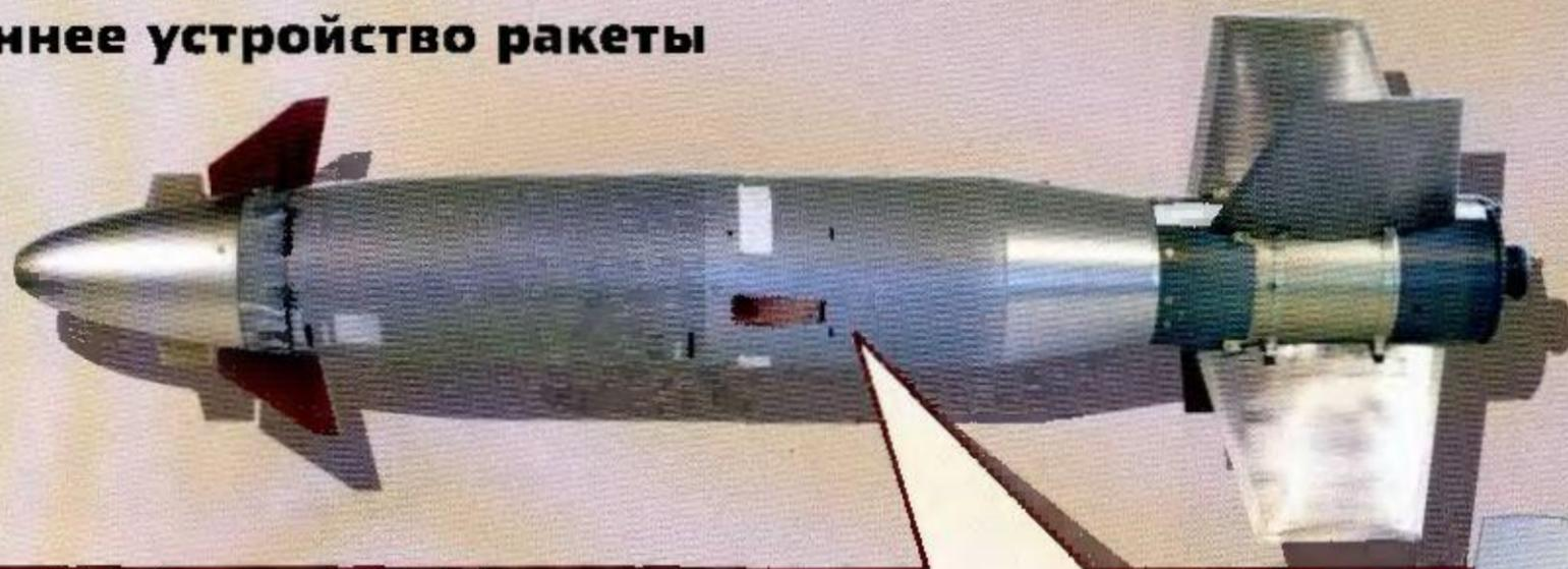
Отличительная особенность компоновки противотанковых ракет 9М 133-1 – размещение разгонного двигателя между лидирующим кумулятивным зарядом и основным кумулятивным зарядом, что позволяет, с одной стороны, защитить основной кумулятивный заряд от осколков лидирующего, обеспечить большую величину фокусного расстояния и, как следствие, увеличенную бронепробиваемость, а с другой стороны – иметь мощный лидирующий заряд, позволяющий преодолевать существующие навесные и встроенные динамические защиты.
