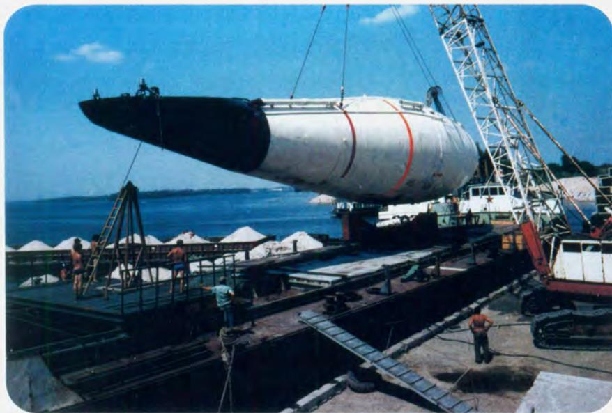
**РАСХОДНАЯ ДЕТАЛЬ** Единственный одноразовый элемент в проекте НПО "Молния" – сбрасываемый после выработки топлива внешний топливный бак. На фото погрузка макета топливного бака предшественника "Клипера" – многоцелевой авиационно-космической системы (МАКС)
