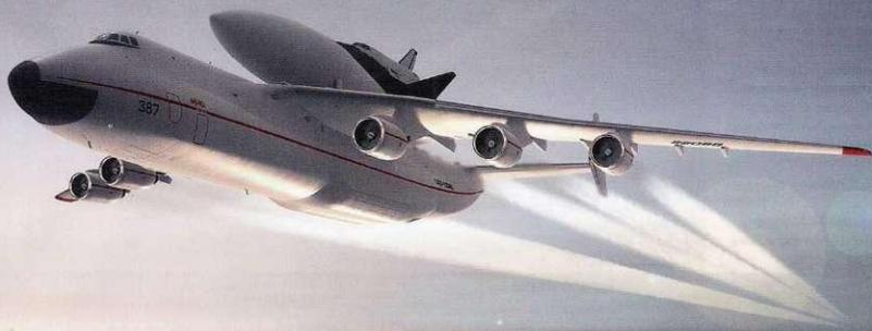
■ ТРАНСПОРТНЫЙ САМОЛЕТ АН-225 “МРИЯ” используется в проекте МАКС в качестве первой ступени. Существует три варианта второй ступени: 1) орбитальный самолет + одноразовый бак с топливными компонентами (МАКС-ОС); 2) беспилотный самолет (МАКС-М); 3) беспилотная вторая ступень с грузом до 18 т (МАКС-Т). Помимо человеческого имени Макс, у системы есть и официальное наименование, гораздо менее благозвучное, – проект 9А-10485.
