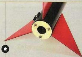
1) Оригинальное крепление двигателя разработки Михаила Деева состоит из пары стекловолоконных колец. От надежности крепления силовой установки зависит стабильность полета ракеты
