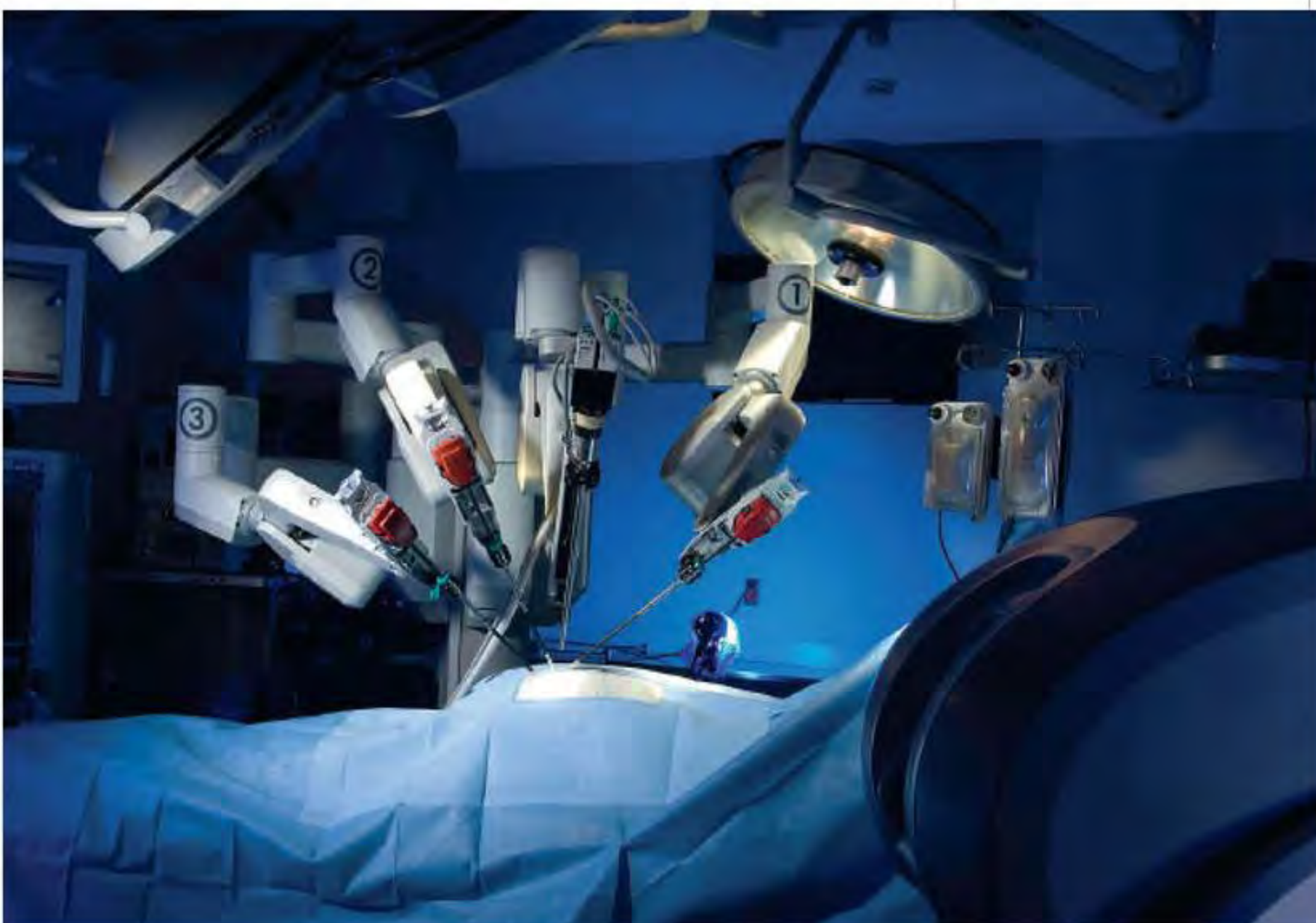
РОБОТИЗИРОВАННАЯ ХИРУРГИЧЕСКАЯ СИСТЕМА , предназначенная для операций на мозге, – прямой наследник роботизированной руки, первоначально разработанной Канадским космическим агентством для перемещения грузов в космосе.
