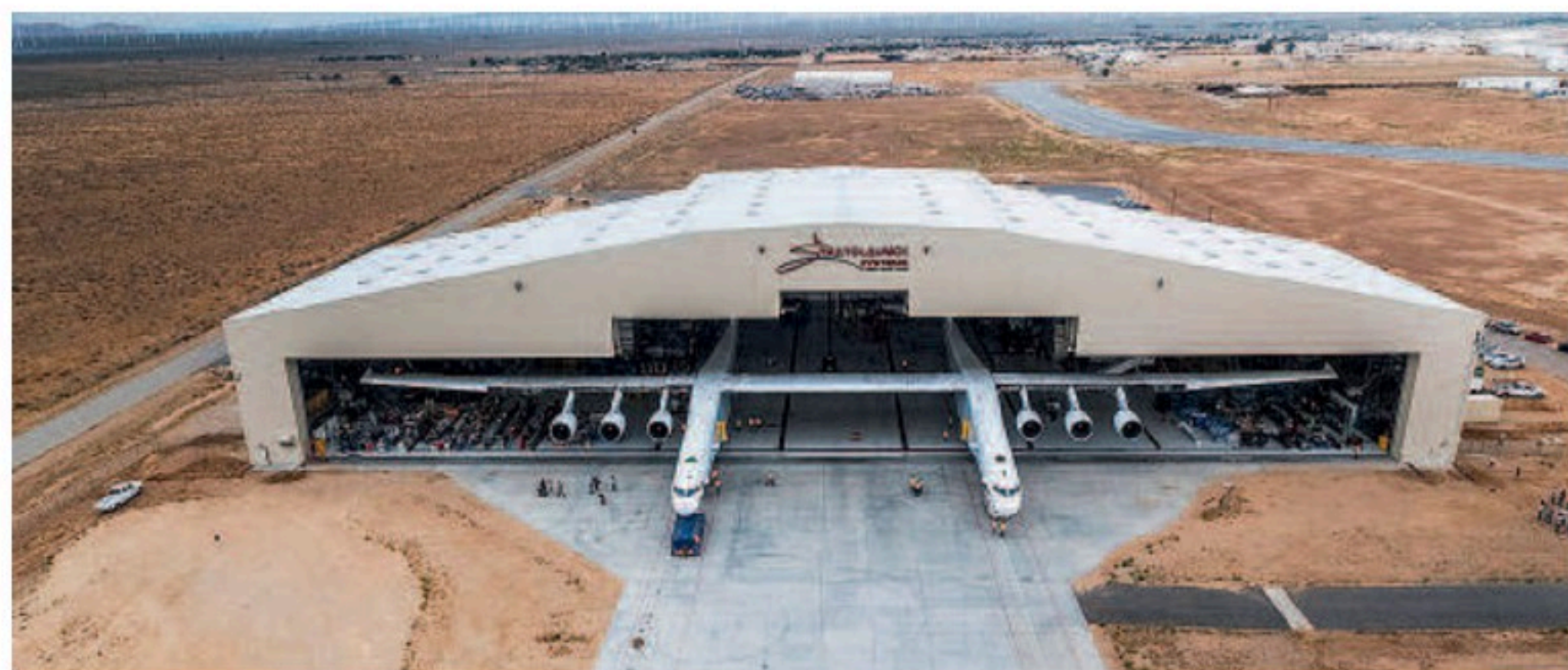
Масса пустого Stratolaunch Model 351 составляет 227 т, максимальная взлетная – 590 т, включая 230 т полезной нагрузки на подвесной системе, которую разрабатывает компания Dynetics.
