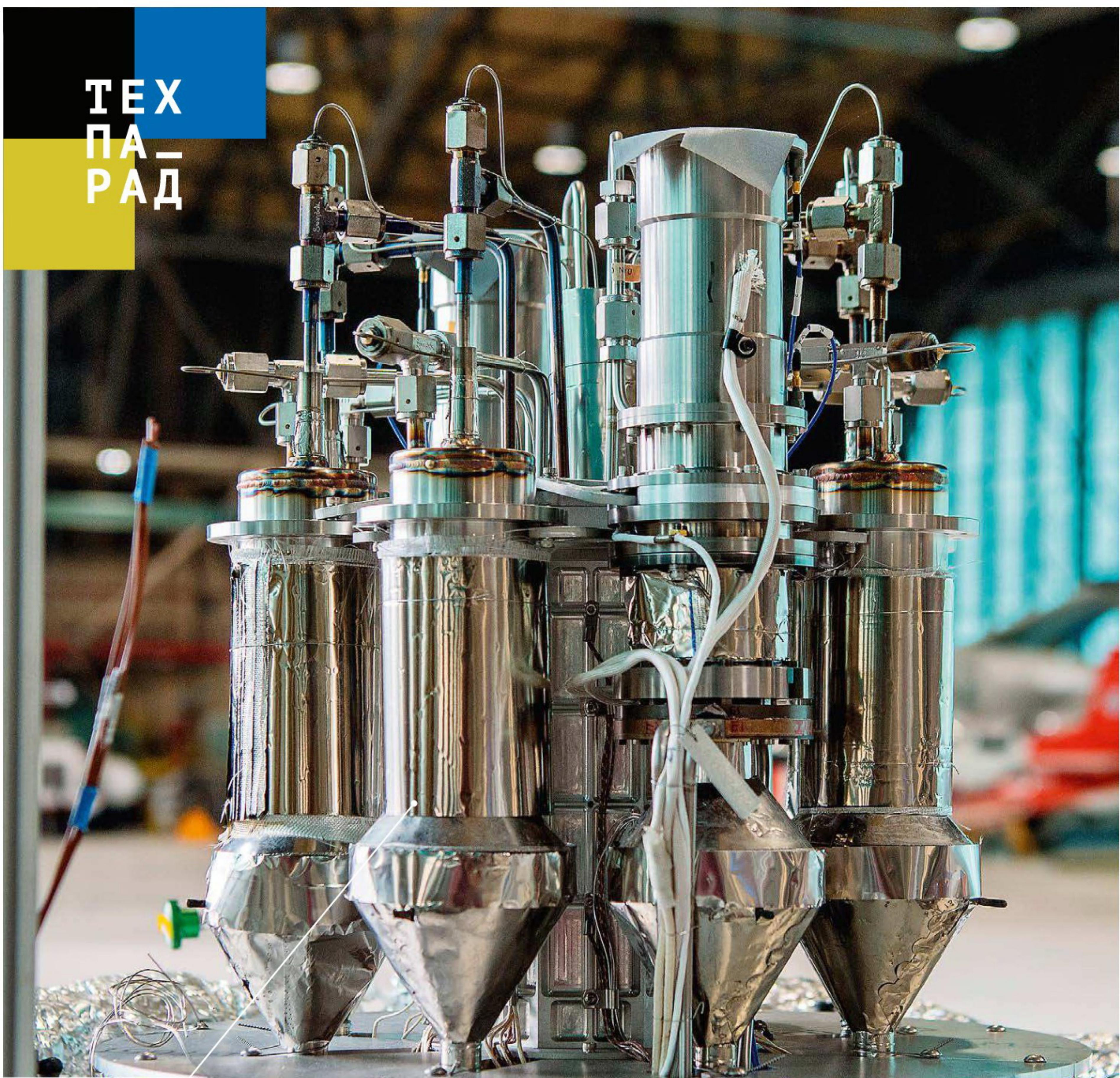
Успешные испытания позволят разработчикам реактора достичь пятого уровня технологической готовности (TRL5) – по принятой в NASA формулировке, это соответствует подтверждению работоспособности в условиях, имитирующих реальные. В будущем такие компактные установки смогут выдавать до 10 кВт в течение 10 и более лет.
