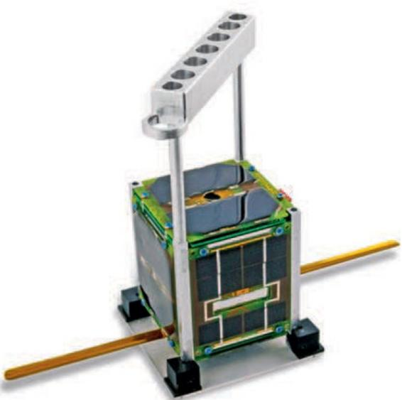
Для запуска с МКС нано-спутник формата CubeSat U1 необходимо определенным образом подготовить. Во-первых, он снабжается ручкой, с помощью которой космонавт, выходящий в открытый космос, удерживает спутник, а затем совершает бросок. Во-вторых, до помещения на борт транспортного корабля, который отправится к МКС, спутник упаковывают в специальный мягкий чехол. Материалы чехла должны быть негорючими и не источать резких запахов.
