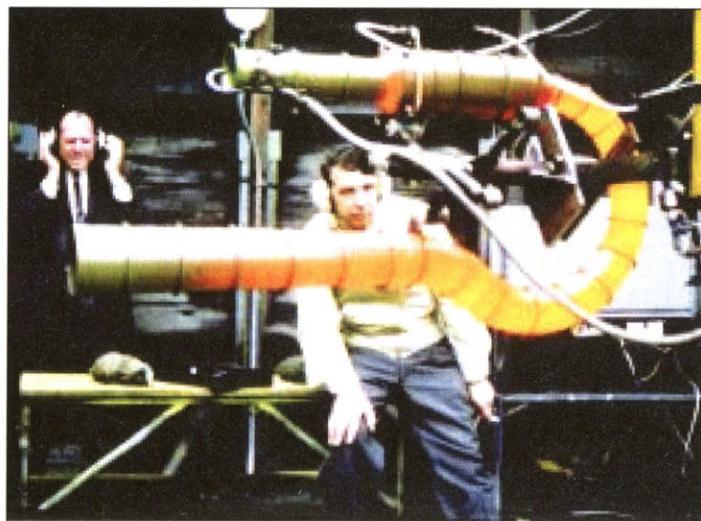
Рис. 3.34. Опытный безэжекторный ПуВРД Локвуда – Хиллера [3]
