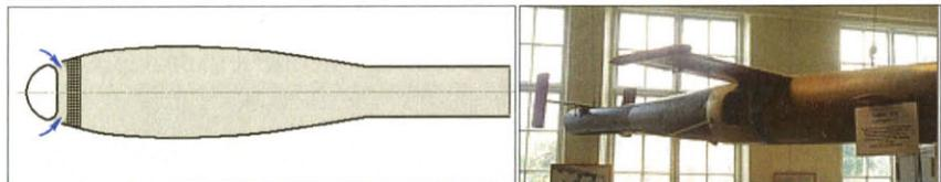
Рис. 2.32. ПуВРД с экранирующим коком на входе в клапанную решетку [2]
