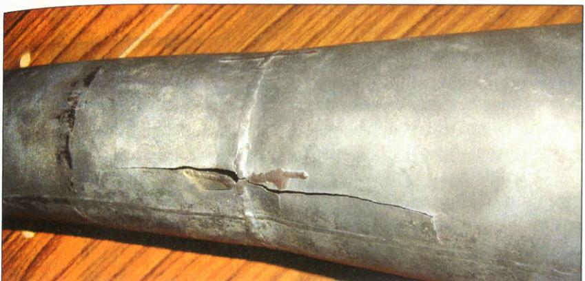
Рис. 2.61. Разрушение камеры в результате суммарной наработки 60 минут в условиях стендовых испытаний [38; 39]
