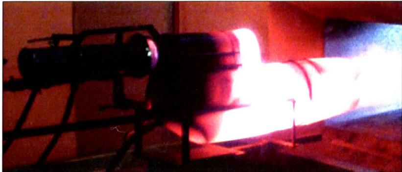
Рис. 3.55. Опытный образец двухэжекторного ЭПВРД
