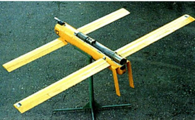
Рис. 3.46. Одноразовый БЛА фирмы «Эникс» – для разведки целей и контроля результатов стрельбы РСЗО «Смерч» [97]
