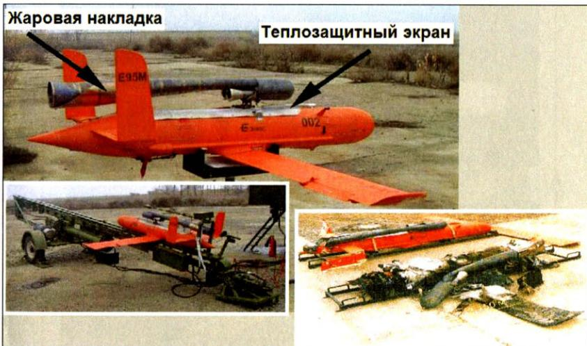
Рис. 3.44. Наиболее известный серийный БЛА с ПуВРД типа ThermoJet – летающая мишень Е-95М «Эникс» [95; 96]
