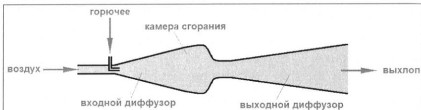
Рис. 3.4. Схема двигателя Ж. Марконне
