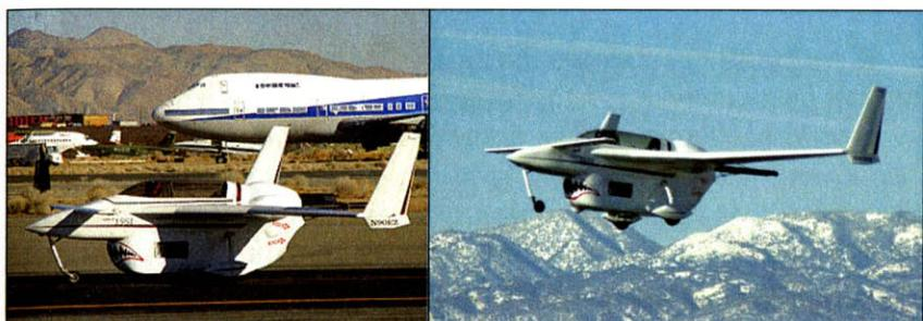
Рис. 5.27. Экспериментальный самолет Long-EZ с ПуДД [154]
