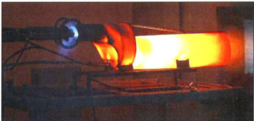
Рис. 3.56. Опытный образец двухэжекторного ЭПВРД
