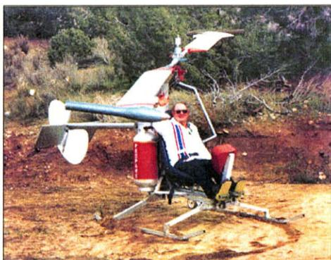
Рис. 4.21. Одна из поздних конструкций вертолета Глухарева с двумя встроеннымми эжекторными ПуВРД
