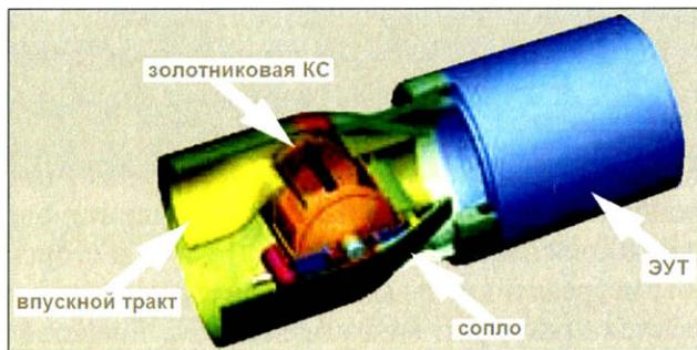
Рис. 5.29. Экспериментальный золотниковый ПуДД с эжекторным усилителем тяги ОАО «НПО «Сатурн» [157; 158]
