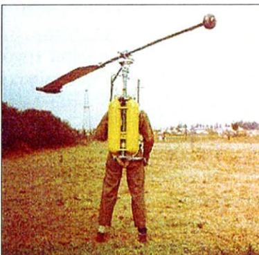
Рис. 4.22. Ранцевый вертолет Глухарева с однолопастным ротором и балансировочным противовесом
