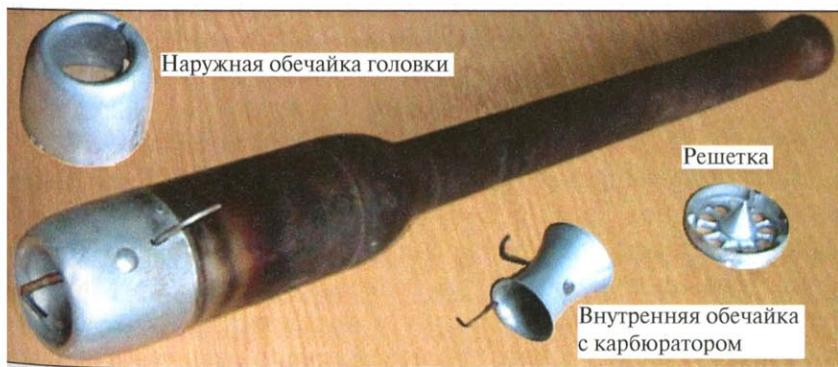
Рис. 2.37. ПуВРД В. Найдовского с бензобаком, встроенным в головку
