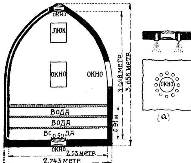
Рис. 9. Разрез ядра Ж. Верна.
