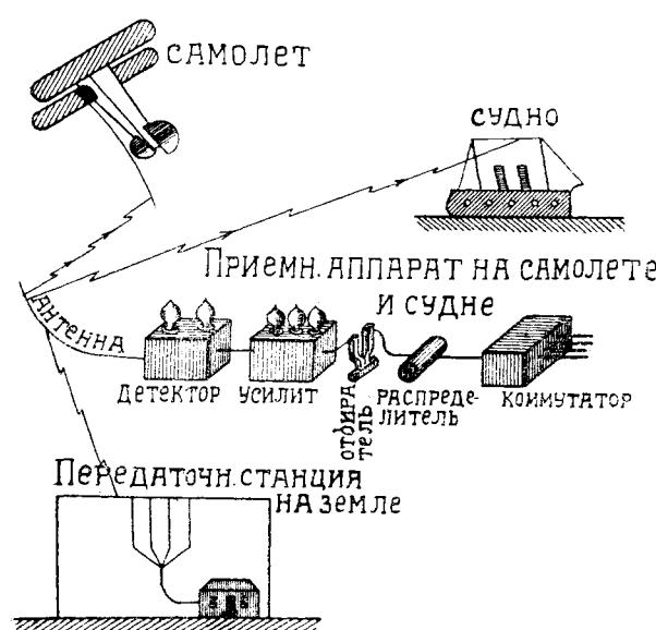
Рис. 72. Общая схема радио-телеинженерической передачи.
