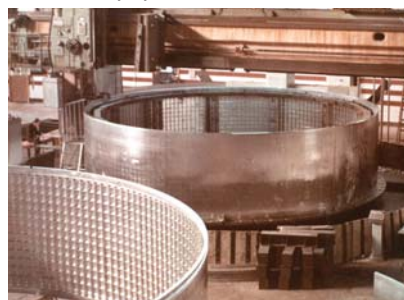
Стапель для сборки-сварки меридиальных швов сферических днищ
