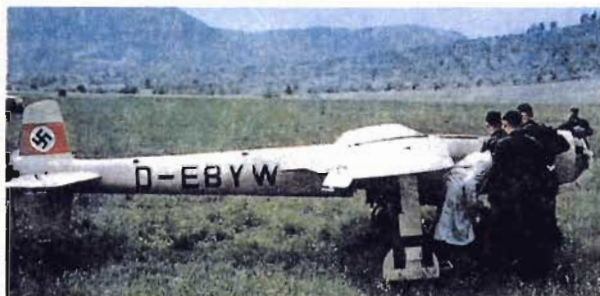
Испытание силовой установки с толкающим винтом на Геттингене Go-9 в июне 1941 г. в Наберне
