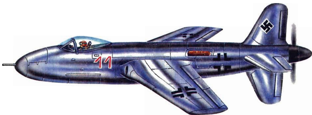
Истребитель «Фокке-Вульф» с двигателем Jumo 222, состояние проекта на октябрь 1944 г.
