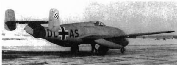
Хейнкель He 280, испытания с макетами двигателей
