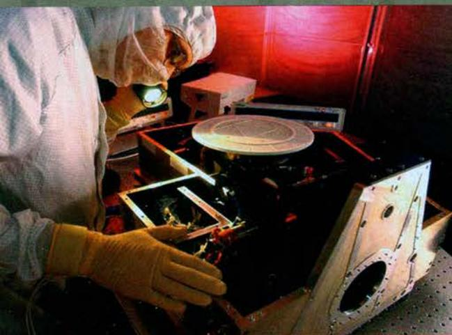
**СПЕКТРОМЕТР** На фото вверх: спектрометр аппарата «Дип Импакт», необходимый для анализа химического состава вещества кометы, выделившегося при столкновении.
