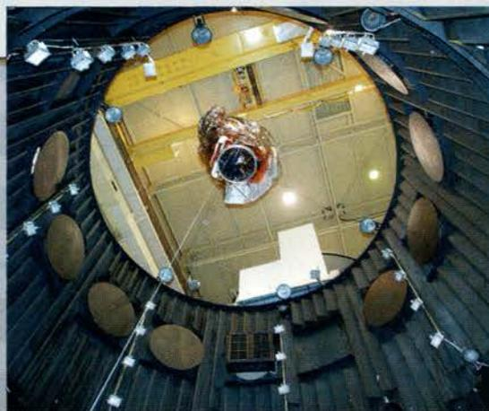
**ИСПЫТАНИЯ ЗАВЕРШЕНЫ** «МЕССЕНДЖЕР» поднимают из термальной вакуумной камеры после пяти недель испытаний.
