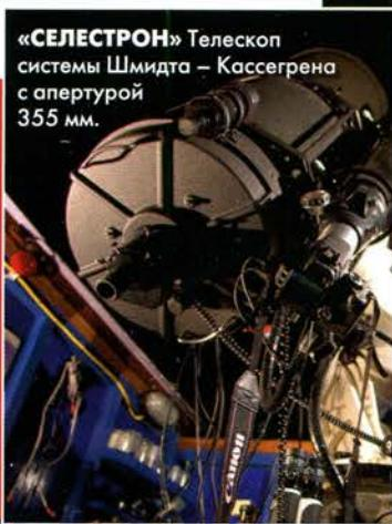
«СЕЛЕСТРОН» Телескоп системы Шмидта – Кассегрена с апертурой 355 мм.
