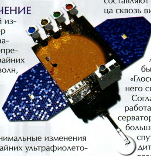
Устройство атмосферного отображения (AIA) состоит из четырех независимых маленьких телескопов, каждый из которых делает снимки света одним и тем же набором инструментов. Оно разработано, чтобы мгновенно снимать изменчивое Солнце в ультравысоком разрешении на разных ультрафиолетовых и крайних ультрафиолетовых волнах. AIA может делать снимки в разрешении IMAX (примерно в 10 раз больше пикселей, чем в стандартной ТВ-картинке в HD-качестве) каждые 10 секунд.
