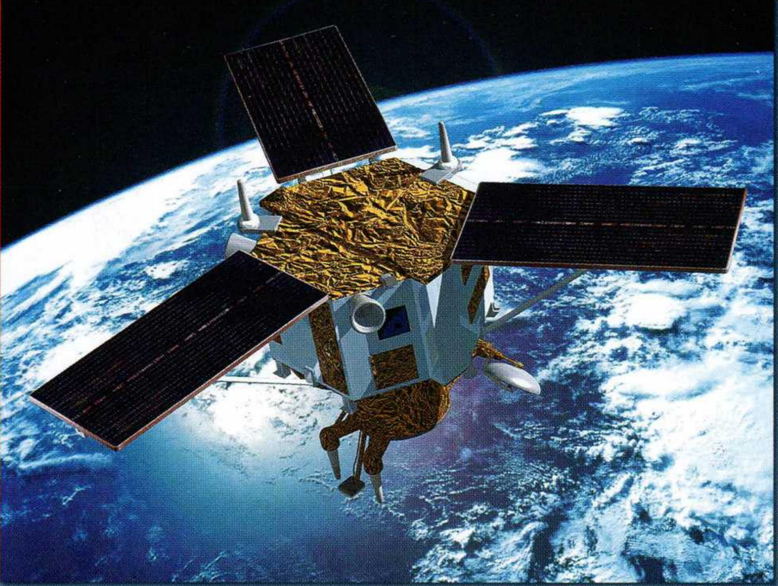
положение спутника в пространстве (см. «Глоссарий») определяется двумя звездными датчиками и одним солнечным и корректируется четырьмя двигателями-маховиками (см. «Глоссарий»).
