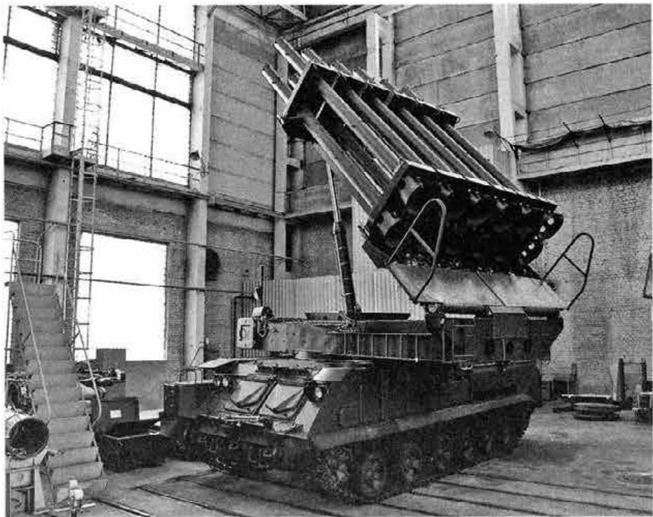
Пусковая установка 9А316М
