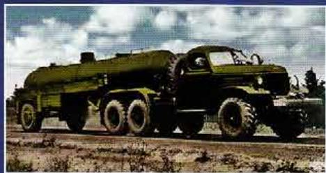
Цистерна ракетного топлива ЗАК-44Ц
