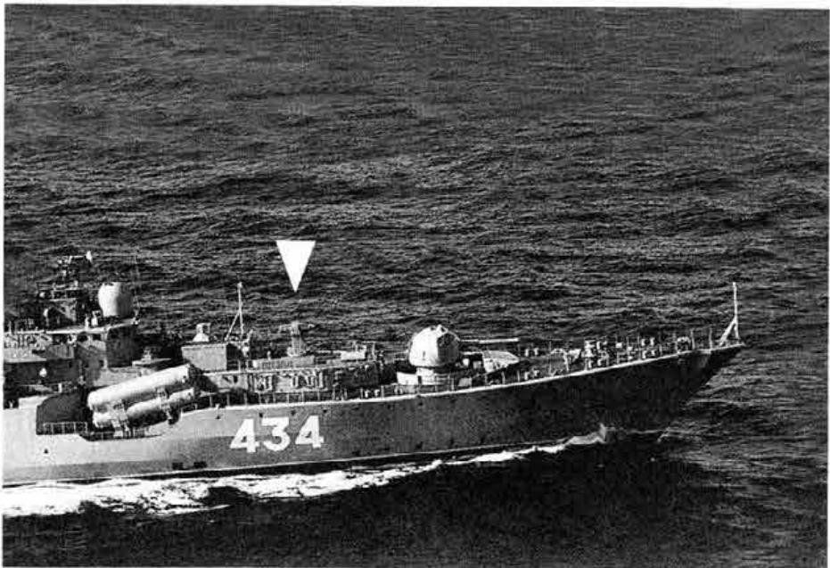
Пусковая установка ЗС-90 на корабле
