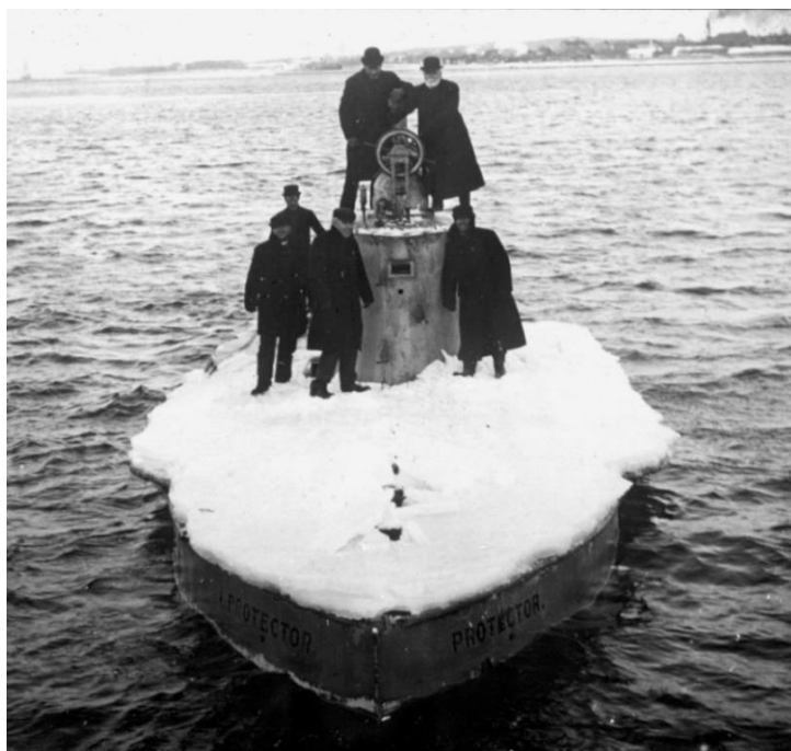
После плавания подо льдами в 1903 г. На крыше рубки установлен штурвал
