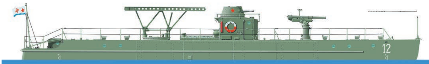
Бронекатер волжской военной флотилии № 12 с пусковой установкой для Реактивных снарядов
