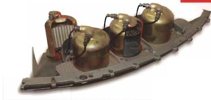
Двигатель мягкой посадки корабля «Союз ТМ»
