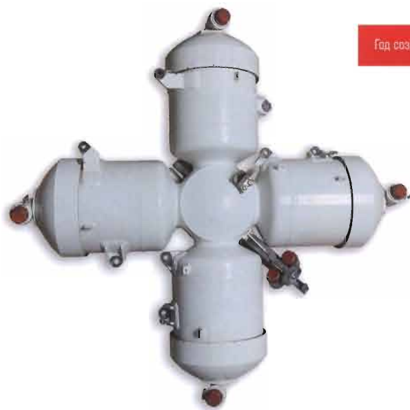
Разгонный блок катапультируемого кресла пилота корабля «Буря»
