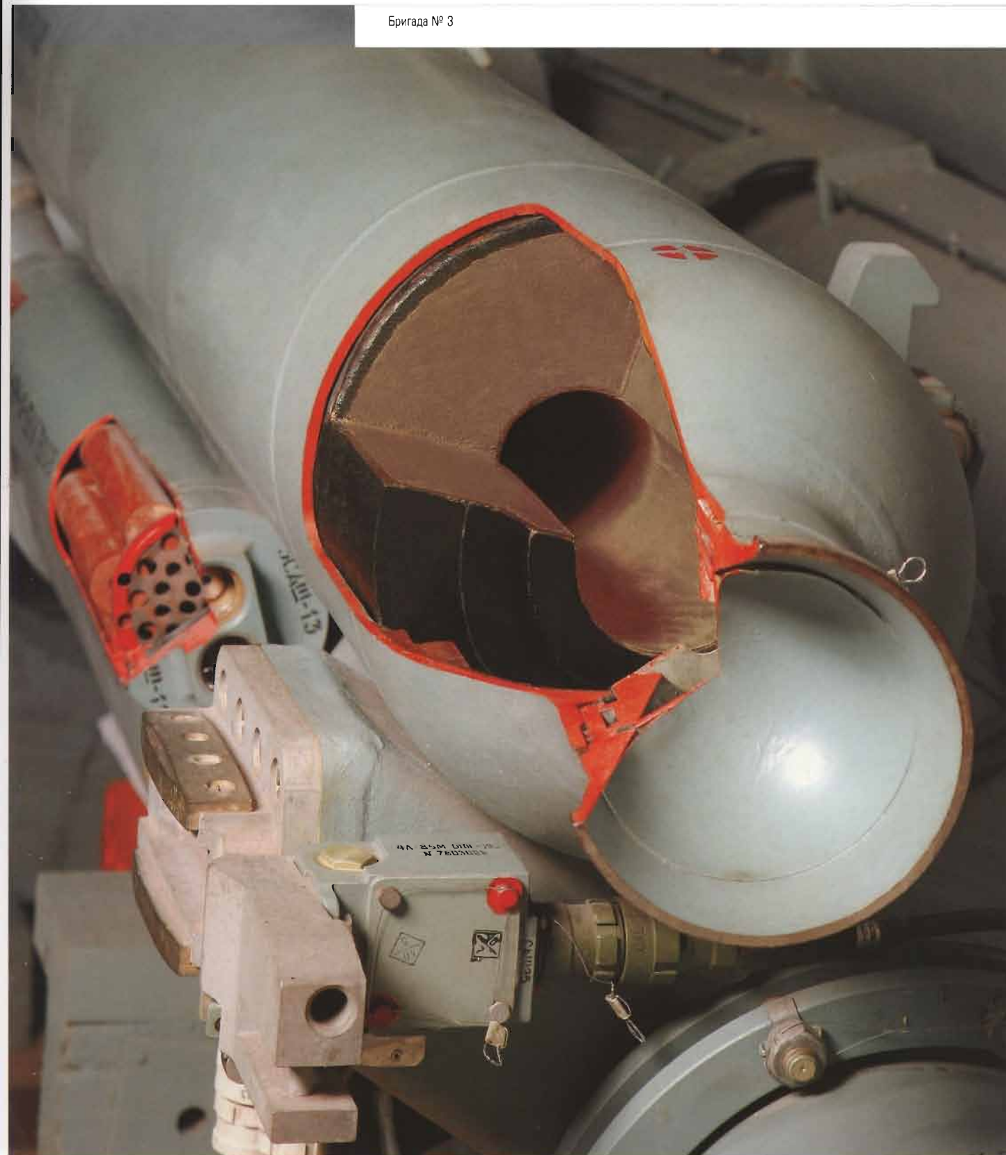
Стартовый агрегат для ракеты «Малахит», предназначен для старта с подводной лодки
