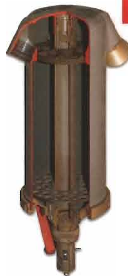
Тянущий механизм 524 системы катапультирования пилота вертолета К-50
