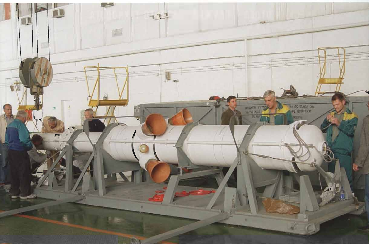
Подготовка ДУ САС к стыковке с РН «Союз» на Байконуре
