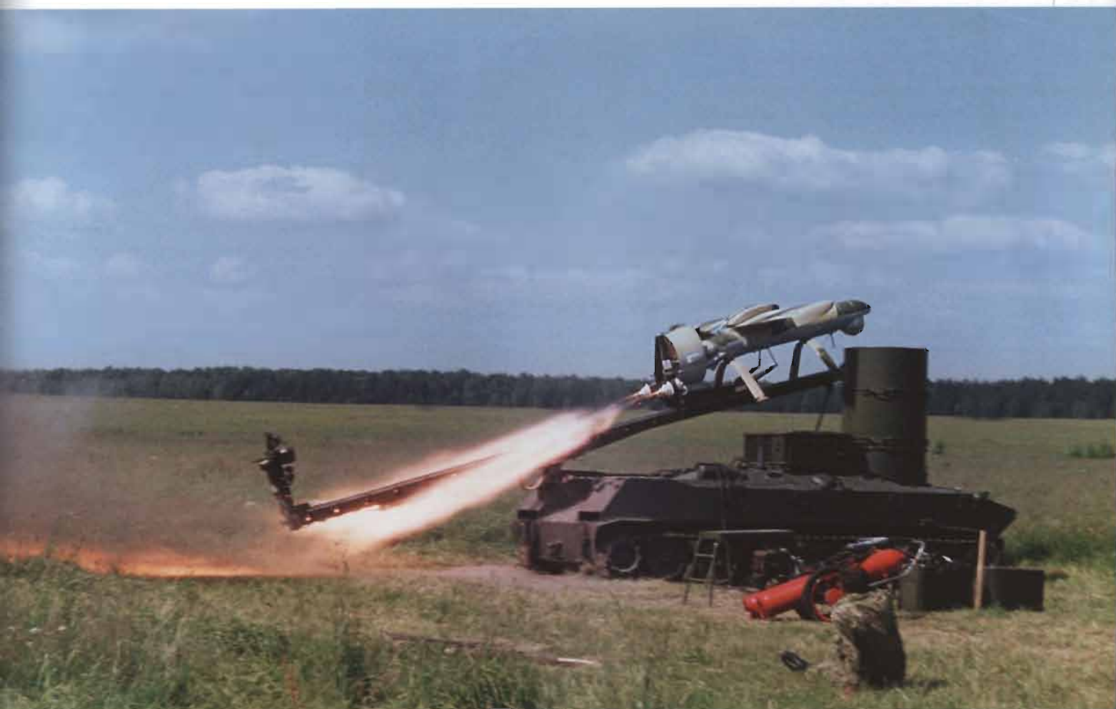
Старт беспилотного самолета-разведчика «Пчела» с ускорителем 541-V
