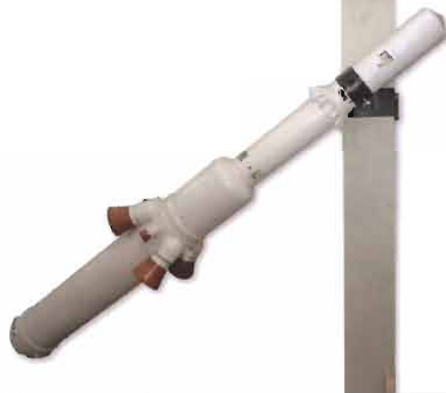
Двигательная установка системы аварийного спасения космического корабля «Союз ТМ»
