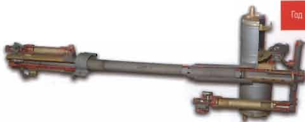
Комбинированный стреляющий механизм катапультируемого кресла пилота самолета
