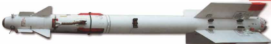
Изделие К-73: двигатель 516-1 с газодинамическим управлением
