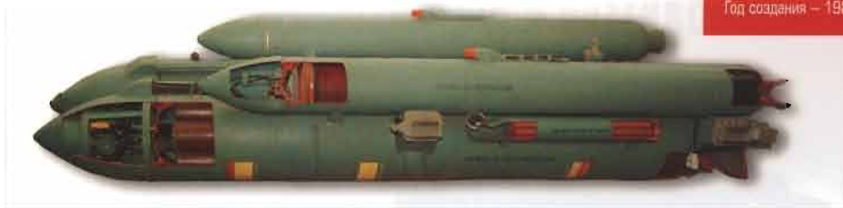
Стартовый агрегат для ракеты «Малахит», предназначен для старта с подводной лодки
