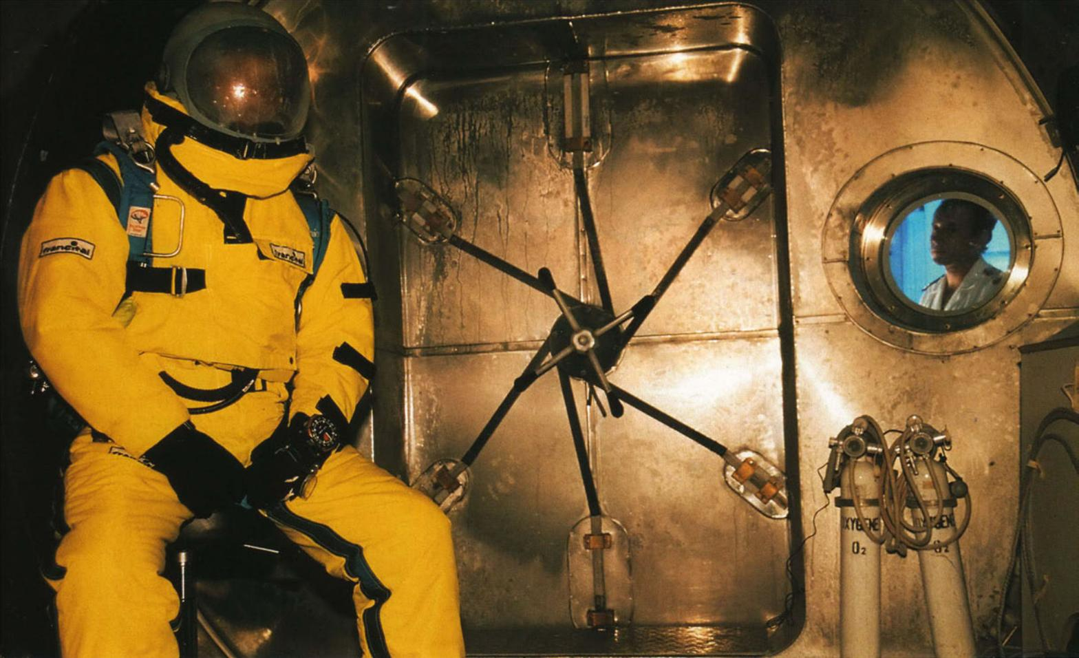
Испытания костюма в камере низкого давления.
