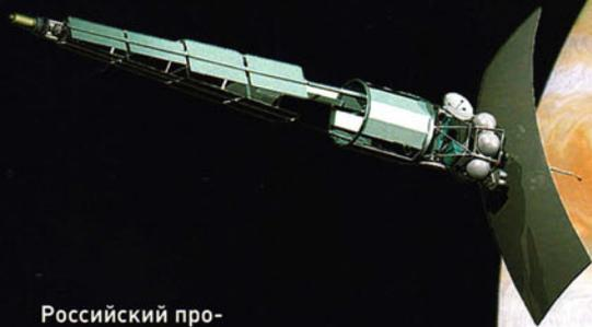
Российский проект станции с ядерным реактором (слева) и ионными двигателями (справа) пока даже не получил названия. Выйдя на рабочую орбиту, станция раскроет антенну радара, которая заслоняет сопла двигателей
