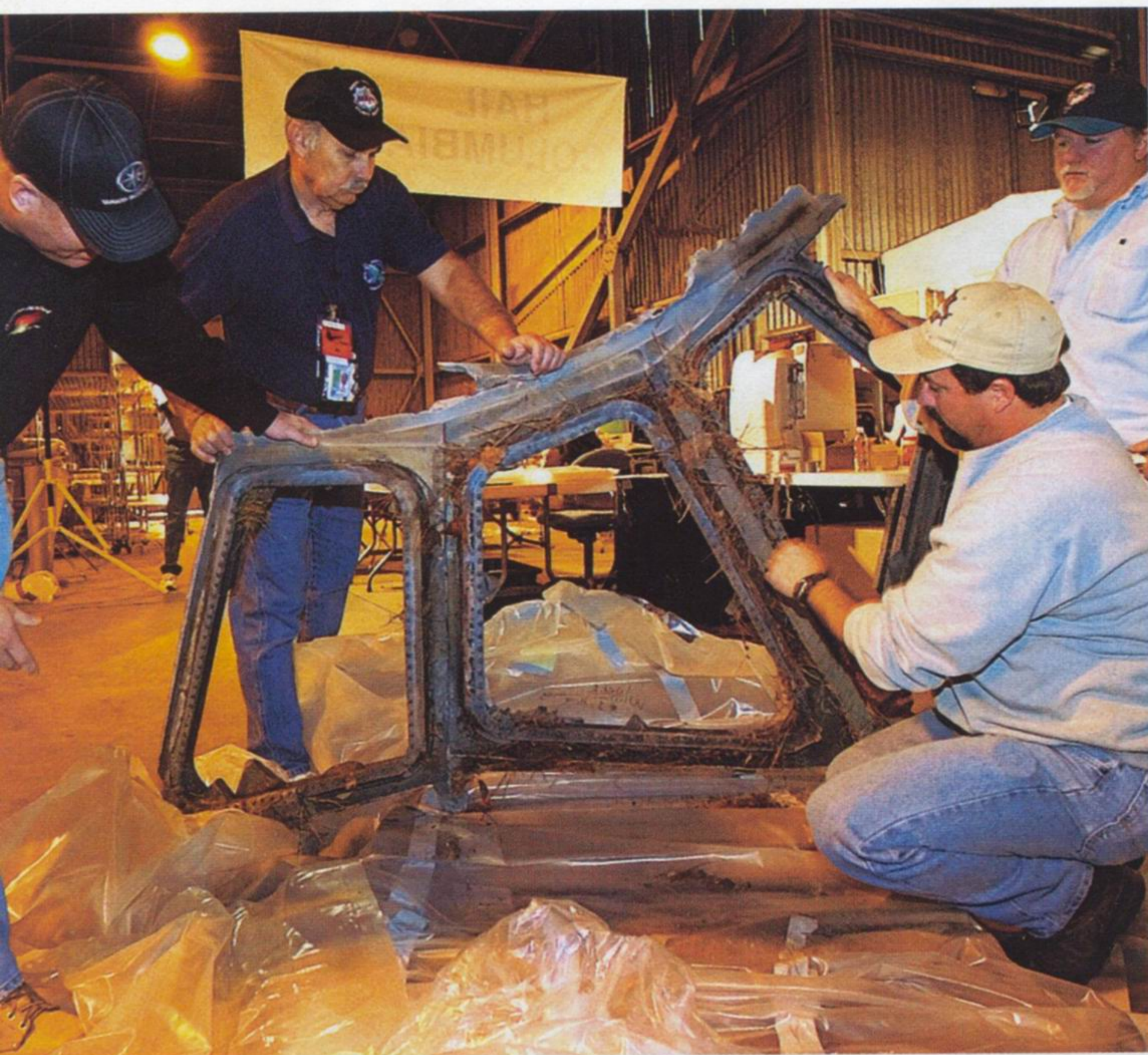
Переплет фонаря пилотской кабины шаттла «Колумбия» — один из самых крупных фрагментов, найденных после катастрофы челнока
