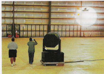
Прожектор передает энергию для пропеллера радиоуправляемой модели самолета (NASA, 2002 год). Но из нескольких киловатт мощности прожектора солнечная батарея принимает и пускает в дело лишь десятки ватт
