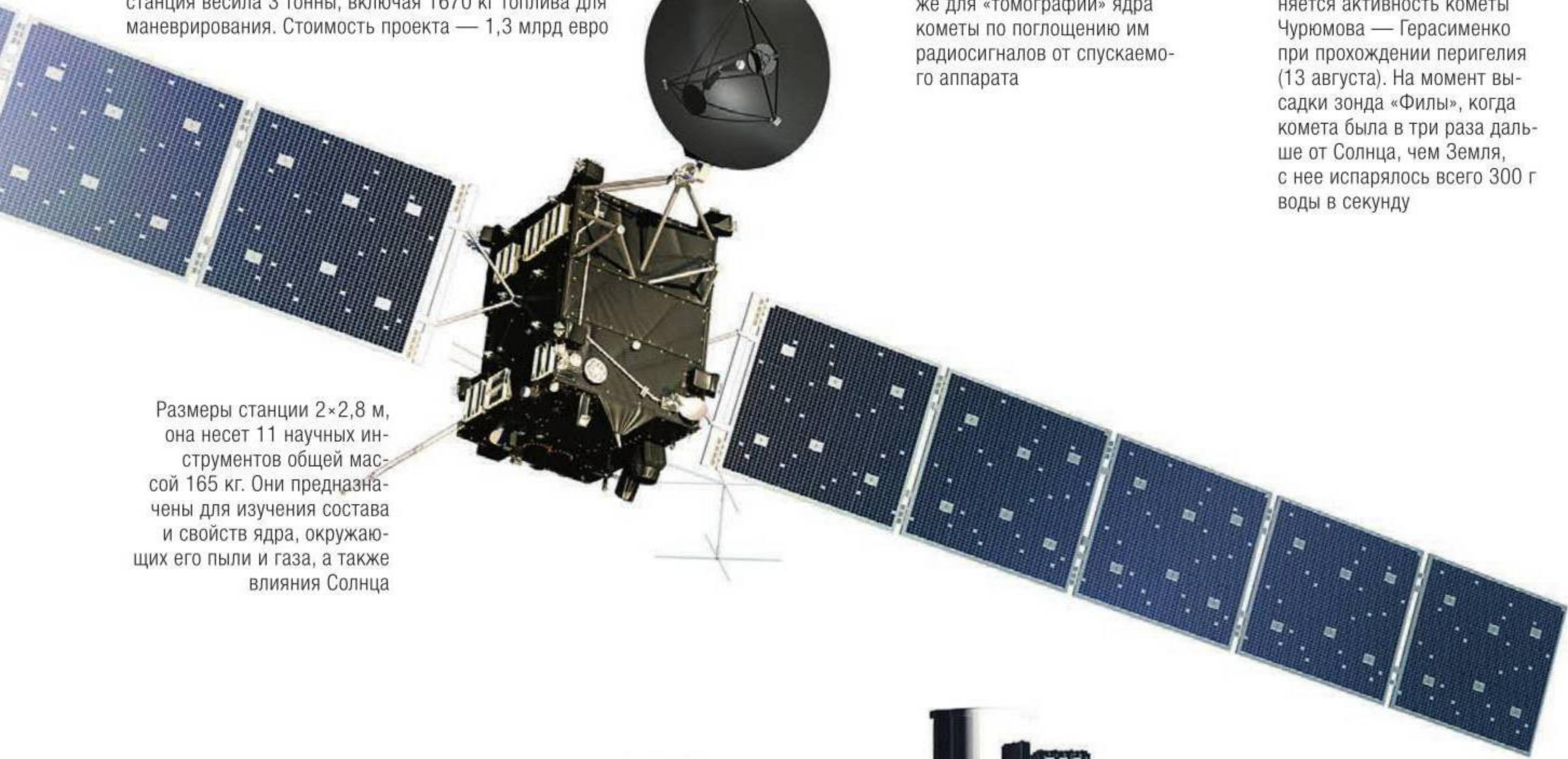
Размеры станции 2×2,8 м, она несет 11 научных инструментов общей массой 165 кг. Они предназначены для изучения состава и свойств ядра, окружающих его пыли и газа, а также влияния Солнца
