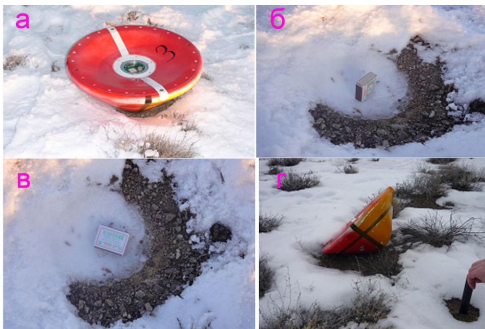
Рисунок 14. Результаты взаимодействия макетов капсулы с грунтом на полигоне посадки
