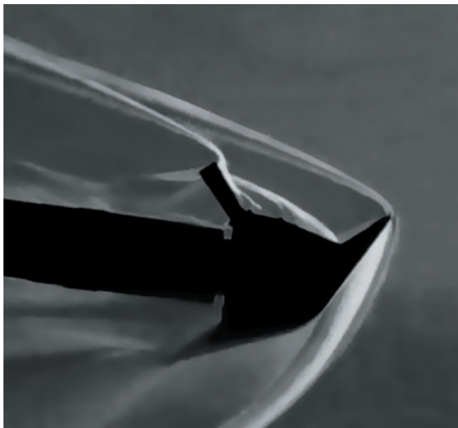
рисунок 3. Модель марсианской станции в аэродинамической трубе при M=6
