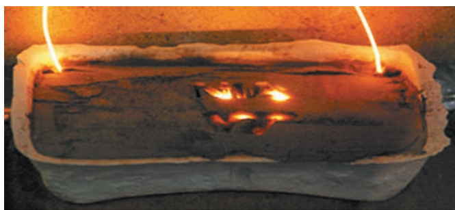
рисунок 3. «Лунный кирпич», изготовленный по методу СВС (Ксандопуло Г.Н., 2013)
