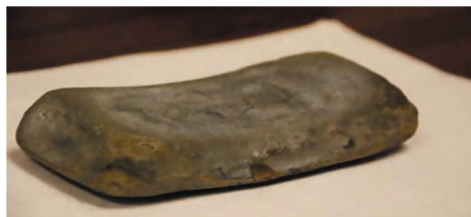
рисунок 3. «Лунный кирпич», изготовленный по методу СВС (Ксандопуло Г.Н., 2013)
