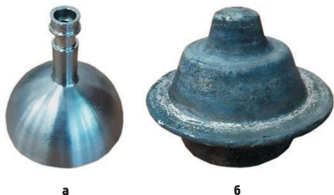
а – деталь после механической обработки; б – поковка.
