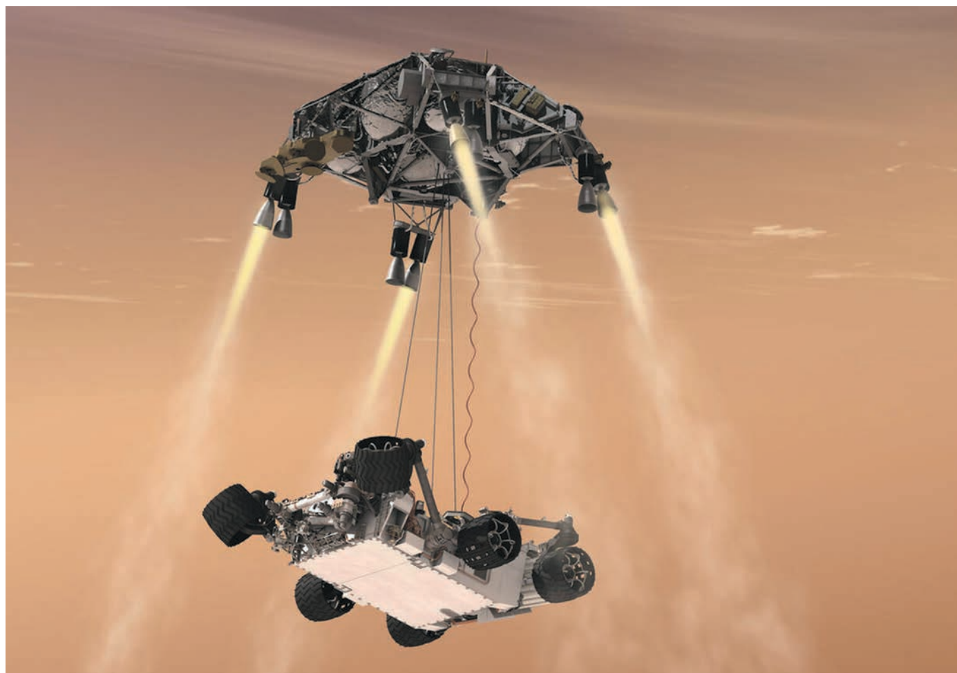
рисунк 10. Схематическое изображение спуска марсохода «Кьюриосити» на поверхность «небесным краном»
