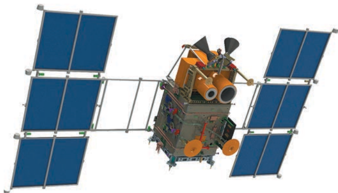
рисунок 3. Общий вид МКА ДЗЗ «Канопус-В» с установленной на нём КДУ
