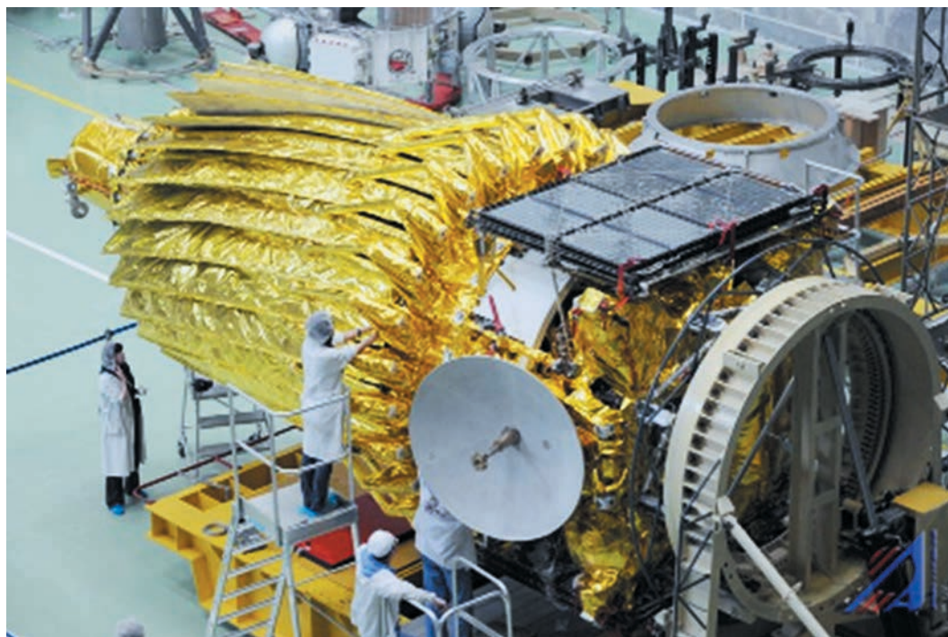
рисунок 6. Кантователь космического аппарата, разработанный и изготовленный при участии Филиала
