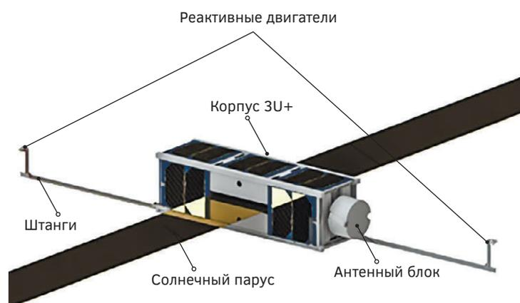
Рис. 1. Пример межпланетного космического аппарата с электронагревным реактивным двигателем
