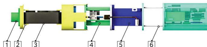
**Рис. 3.** Схема расположения блоков летательного аппарата «Метелица»
