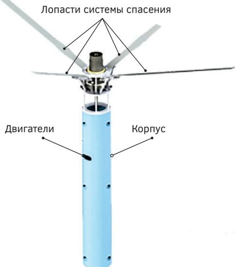
**Рис. 2.** Конструкция летательного аппарата «Метелица»
