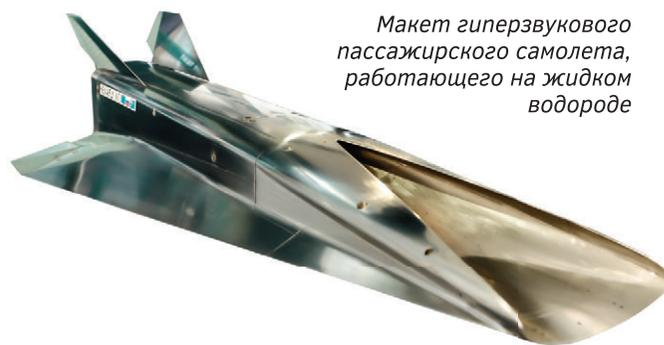
*Макет гиперзвукового пассажирского самолета, работающего на жидком водороде*
