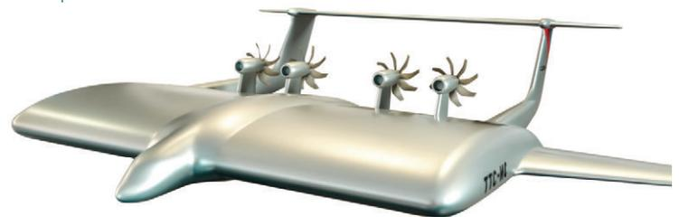
*Макет тяжелого транспортного самолета интегральной схемы (ТТС-ИС)*
