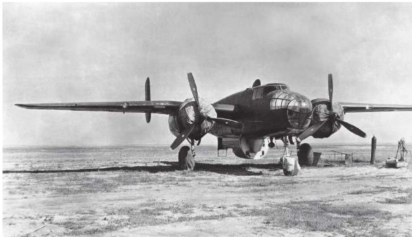
Рис. 6. Бомбардировщик B-25 с отделяемой кабиной самолета «346» под фюзеляжем
