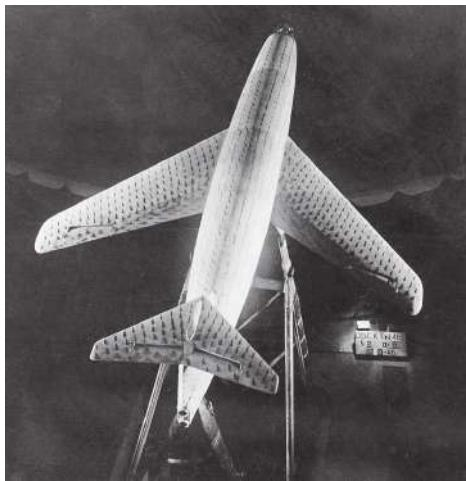
Рис. 4. Исследование «346» в аэродинамической трубе ЦАГИ
