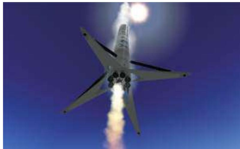
*Рис. 10. Изображение конструкции посадочного устройства первой ступени ракеты-носителя Falcon 9 в процессе посадки*
