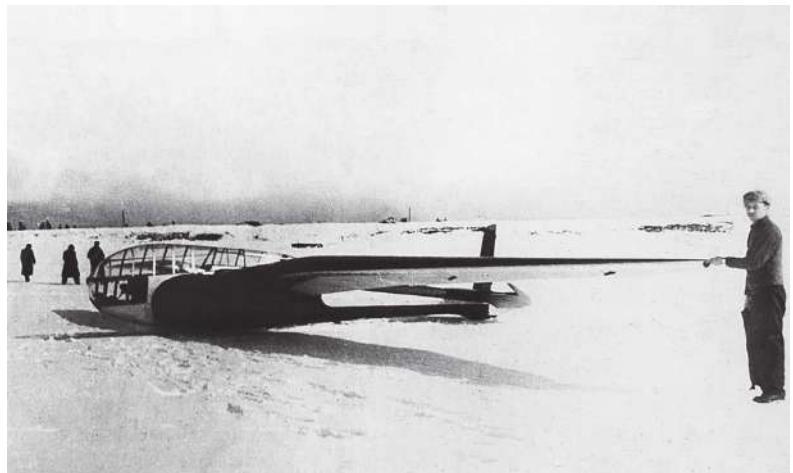
Рис. 5. Планер «Краних», модицированный для пилотирования в лежачем положении
