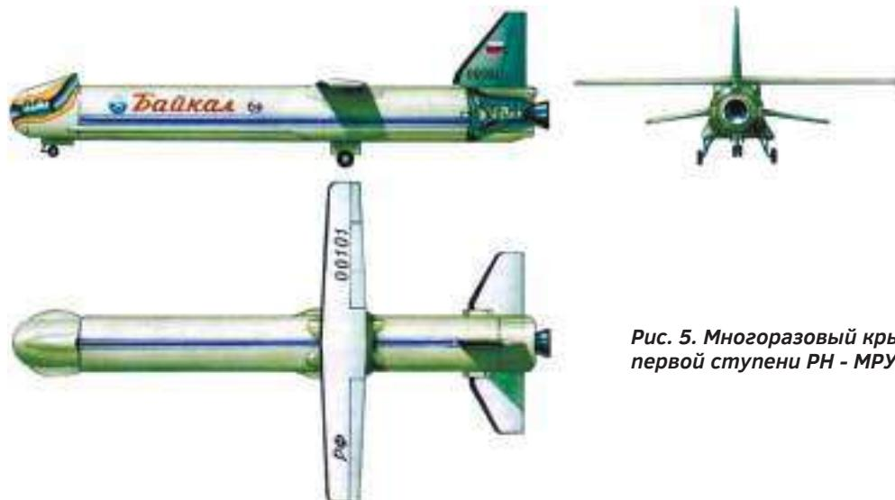
Рис. 5. Многоразовый крылатый ускоритель первой ступени РН - МРУ «Байкал»
